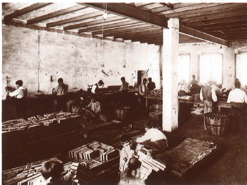
Miquel, Vincke & Meyer. Febrer 1920. Preparant i enganxant quadrats per fer paper de suro
