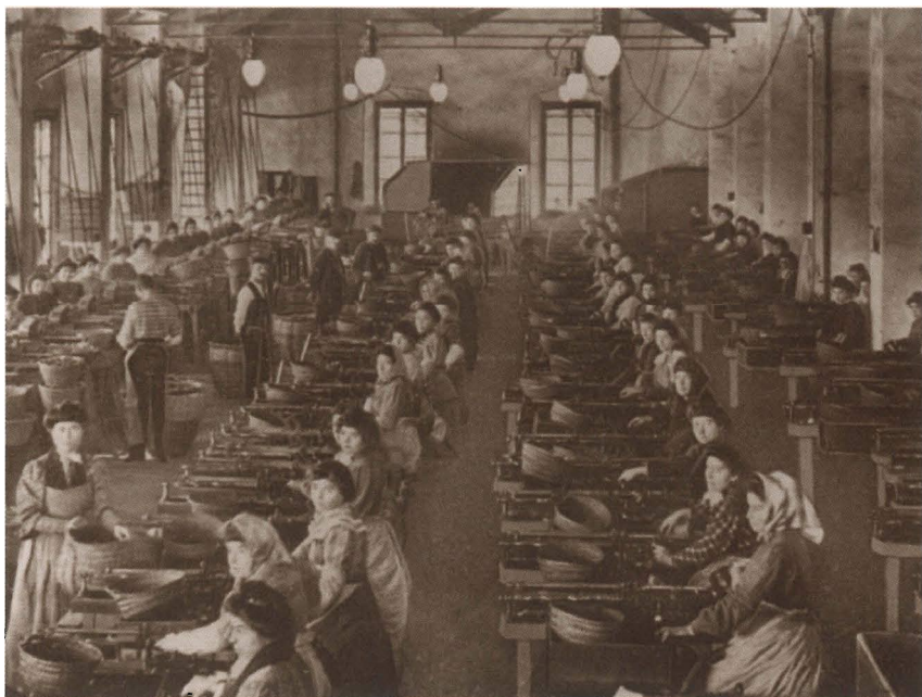
Palafrugell, 1909. Fent taps amb màquina de ribot a Miquel, Vincke & Meyer
