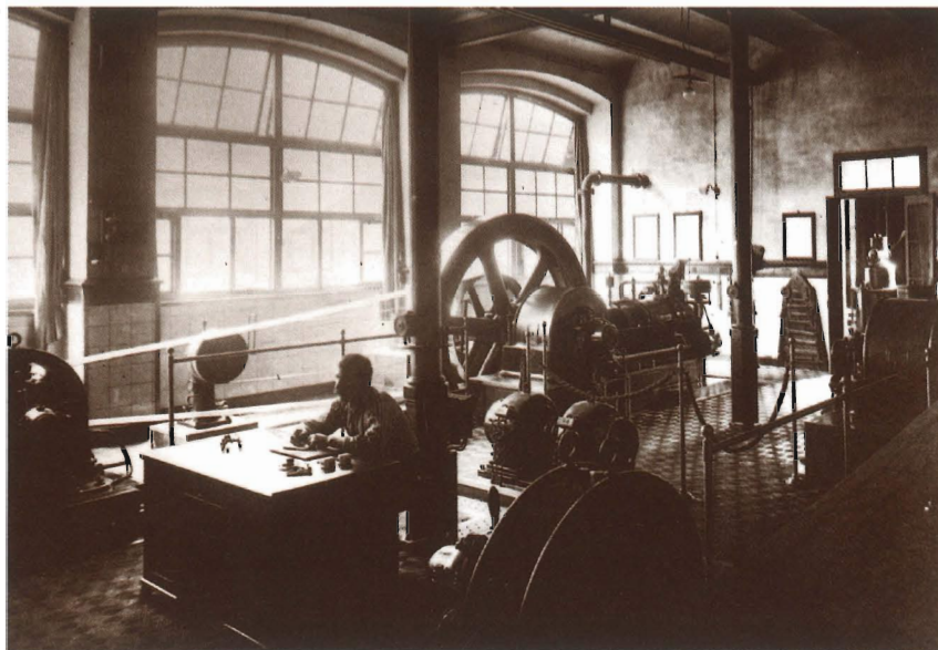
Manufacturas de Corcho, S.A. Sala de generadors i motor de gas pobre
