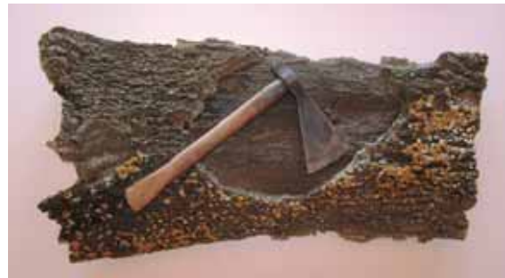
Destral de pela, on es distingeix el tascó i el final en forma de cunya.
