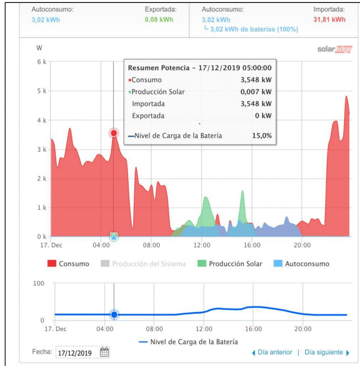
Figura 10. Imatge software de control producció i aprofitament.
